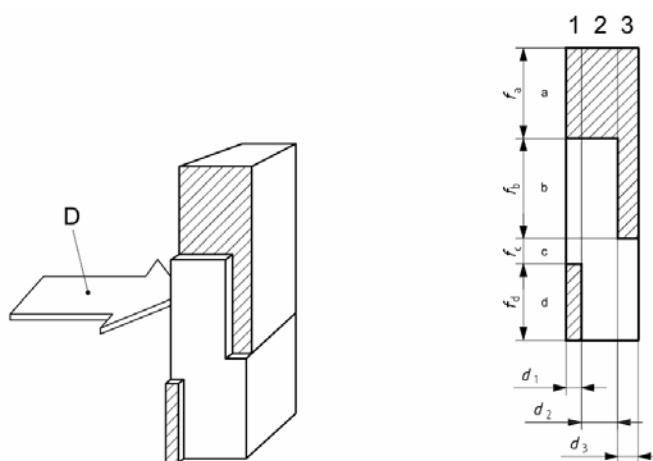
Slika 3.1 Odsječci i slojevi toplinski nehomogenog građevnog dijela
