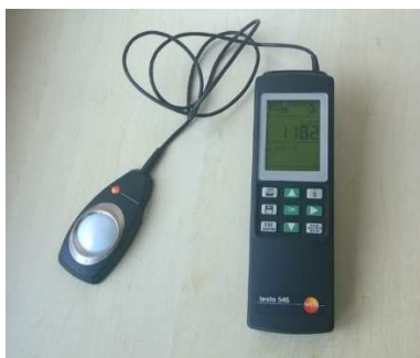
Slika 3-42 Luksmetar za mjerenje osvijetljenosti
