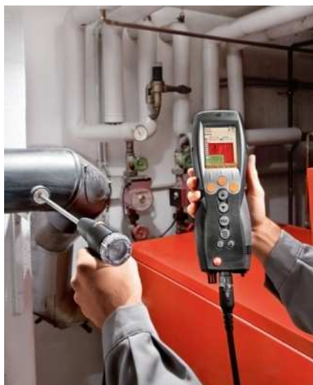
Slika 3-47 Mjerenje sastava dimnih plinova na izlazu iz kotla uređajem za mjerenje sastava dimnih plinova
